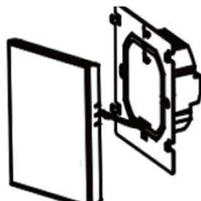
Connettere il termostato secondo lo schema elettrico. Fissare la piastra di montaggio al muro con le viti fornite.
