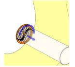
Arrotolare l'isolante e inserirlo una prima volta all'interno del condotto fino alla battuta. Misurare la distanza che separa l'isolante dall'imbocco del condotto: deve essere almeno di 28 cm. Se fosse inferiore, estrarre l'isolante e tagliare la parte eccedente. Inserire nuovamente l'isolante nel condotto. Inserire il corpo centrale del dispositivo, che deve andare in battuta senza spingere in fuori la griglia.
