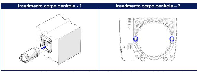
Inserire il corpo centrale nel condotto con il cavo del ventilatore in basso e le 2 linguette di presa (destra e sinistra) centrate come in figura.
