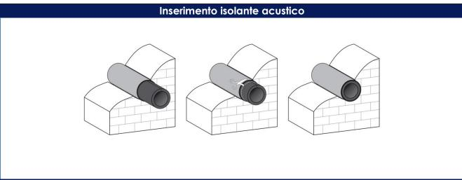
Arrotolare e inserire nel condotto l'isolamento acustico. Inserire una prima volta l'isolamento all'interno del condotto fino alla battuta, Segnare sulla circonferenza dell'isolante il tratto di isolante da rimuovere affinché sia a filo del condotto. Estrarre l'isolante e tagliare la parte eccedente.
