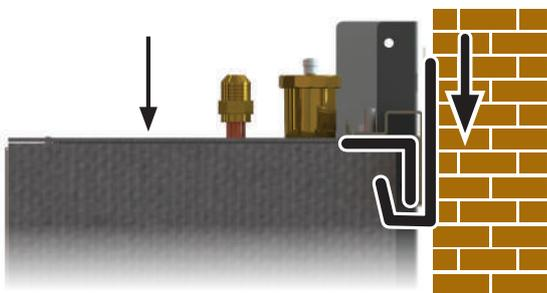
**E)** Bloccare saldamente l'unità interna alla parete retrostante con 2 tappi a muro da applicare sui 2 fori presenti nei montanti verticali (vedi figura sottostante).
