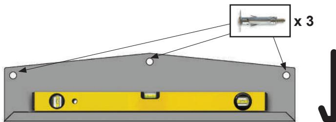
**B)** Una volta segnata la posizione dei fissaggi, realizzare dei fori appropriati per l'inserimento dei tappi a muro da scegliere in base al peso dell'unità interna in esercizio ed in base alla tipologia strutturale della parete.
