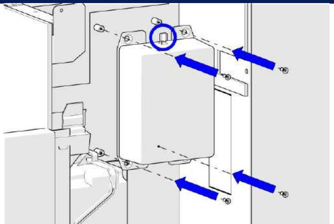
Posizionare il comando elettrico con quattro viti, assicurandosi che il ricevitore a infrarossi sia posizionato verso l'alto.
