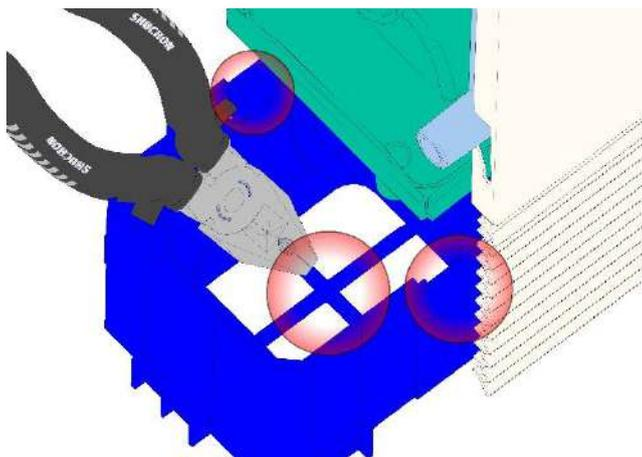
Installare lo scarico condensa (il primo tratto di flessibile isolato è in dotazione con l'apparecchio):
