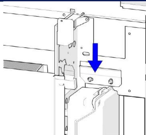
Dettaglio del telaio SLIM A INCASSO che si ancora alle staffe di sostegno. Verificare che Targa sia saldamente inserito tirando verso di sé.
