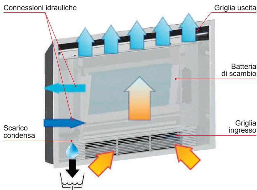
In estate l'unità aspira dalla griglia frontale l'aria calda e umida e la convoglia in maniera silenziosa mediante il ventilatore DC Inverter attraverso la batteria di scambio termico. La batteria preleva calore dall'aria, raffreddandola e deumidificandola, e lo trasferisce al circuito idraulico alimentato con acqua fredda. Attraverso la griglia superiore l'aria, raffreddata e deumidificata, ritorna in ambiente.
