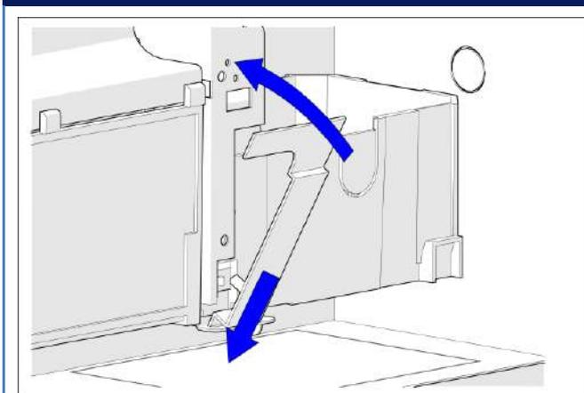
Inserire il fermafiltro nella linguetta presente su SLIM A INCASSO e ruotarlo fino a che il magnete non faccia presa.
