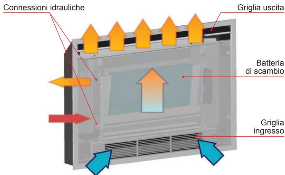
In inverno l'apparecchio aspira dalla griglia frontale l'aria fredda e la convoglia in maniera silenziosa, mediante un ventilatore tangenziale asimmetrico accoppiato a un motore DC Inverter, attraverso una batteria di scambio termico. Compito della batteria è di trasferire il calore proveniente dal circuito idraulico all'aria, riscaldandola. L'aria riscaldata viene immessa nell'ambiente attraverso l'apertura orientabile superiore.
