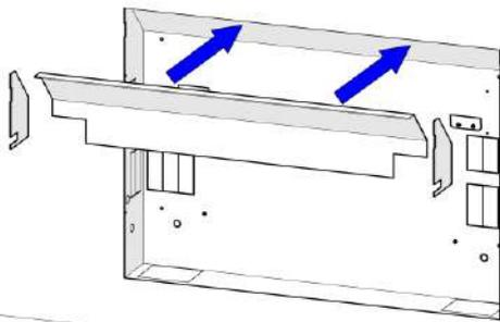
Incollare, come in figura, sul fondo e sui lati della cassaforma gli isolanti adesivi in dotazione.
