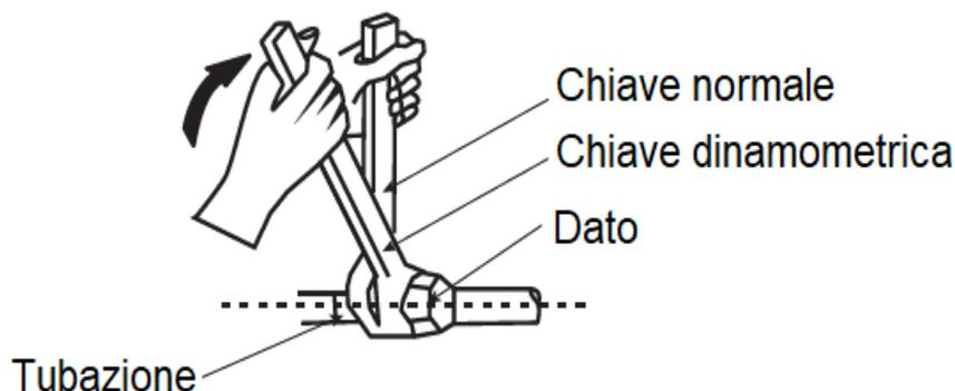
Posizionare il tubo del refrigerante nel dado in ottone ed espandere la boccola del tubo. Fare riferimento alla tabella seguente per le dimensioni del manicotto del tubo e la coppia di serraggio corretta
