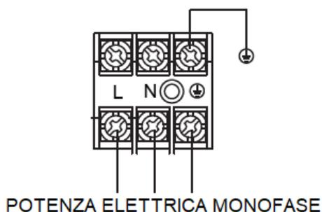
Quando si collega al terminale di alimentazione, utilizzare il terminale di cablaggio circolare con il rivestimento isolante.
