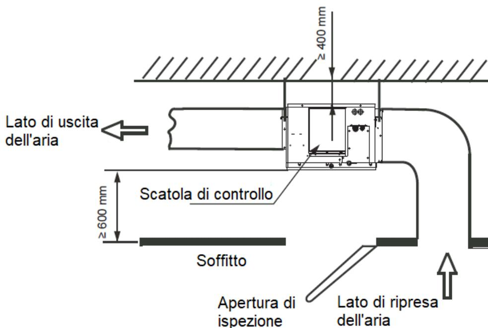
Accertarsi che la pendenza minima per lo scarico dell'acqua sia maggiore di 1/100 e che il corpo dell'unità sia inclinato verso il lato di scarico.
