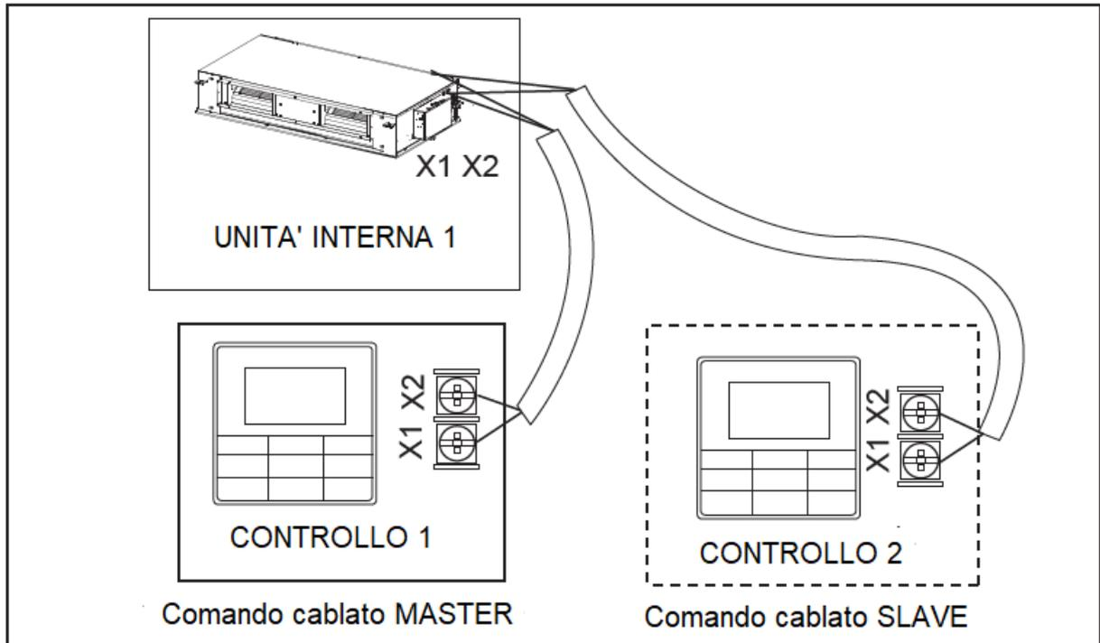
Utilizzare 1 comando cablato per controllare più unità interne, oppure 2 comandi cablati (un comando master e uno slave) per controllare più unità interne (vedere la figura);
