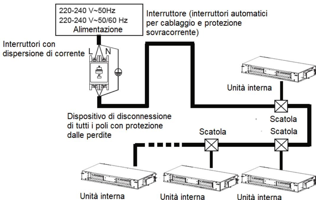
Vedere le tabelle per le specifiche del cavo di alimentazione e del cavo di comunicazione. I cavi a bassa capacità surriscaldano i cavi e possono causare incidenti quando l'unità viene bruciata e danneggiata.
