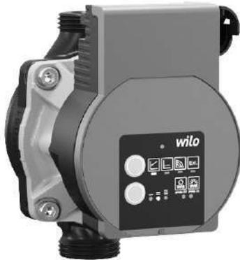
Pompa ad alta efficienza PICO-STG, regolata elettronicamente. Pompa di ricircolo con rotore bagnato esente da manutenzione con attacco filettato, motore sincro autoprotetto secondo tecnologia ECM e regolazione elettronica integrata della potenza per la regolazione modulante della pressione differenziale. Impiegabile in tutte le applicazioni di riscaldamento e condizionamento, nonché per tutti gli impianti geotermici e a energia solare.
