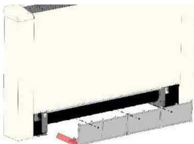
Pulire il filtro con acqua (o sostituirlo se necessario) e riposizionarlo nello stesso modo in cui si è estratto:
