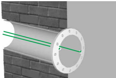
Inserire il braccio nel foro praticato nel muro e spingere l'anello verso l'esterno; tirare delicatamente verso di sé le corde in nylon e manipolare l'anello in gomma fino a che si adatterà al muro esterno.
