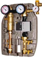
Gruppo di circolazione 2÷12 l/min con collegamenti di mandata e ritorno da 3/4" M. Circolatore Wilo Yonos Para ST 25/7 con pressacavo, misuratore regolatore di portata con valvole di carico e scarico impianto, valvola a sfera flangiata a 3 vie DN20 con valvola di non ritorno 10 mbar provvista di maniglia porta termometro, gruppo di sicurezza 6 bar con manometro Ø 50 mm
