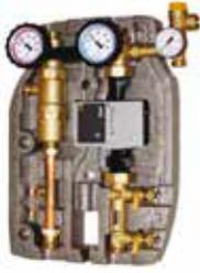
Unité de circulation 2 + 12 l / min avec raccords départ et retour 3/4 "M. Circulateur Wilo Yonos Para ST 25/7 avec presse-étoupe, régulateur de débit avec vannes de remplissage et de vidange du système, vanne à boisseau sphérique à brides 3 voies DN20 avec 10 Clapet anti-retour mbar équipé d'une poignée porte-thermomètre, groupe de sécurité 6 bar avec manomètre Ø 50 mm
