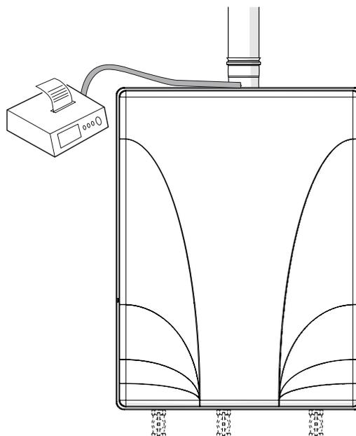
Nel caso i valori di CO<sub>2</sub> non corrispondano, agire gradualmente sulla vite di regolazione gas MAX posta sulla valvola gas fino a rilevare sull'analizzatore i valori di combustione corretti.
