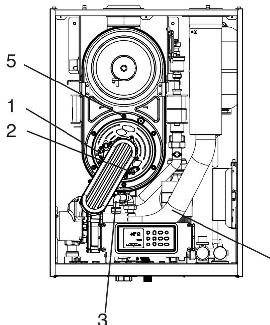
Pulizia dello scambiatore primario condensante e del bruciatore
