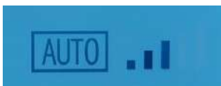
Fig. 51: Sonda 0-10V presente con ventilazione funzionante in manuale alla media velocità / 0-10V probe present with manual ventilation at medium speed
