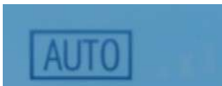
Fig. 49: Sonda 0-10V presente e regolazione della ventilazione automatica / 0-10V probe present and automatic ventilation adjustment
