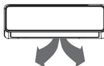
La presa d'aria orizzontale salirà e scenderà automaticamente quando si preme il pulsante Swing. Premere di nuovo per fermarla.
