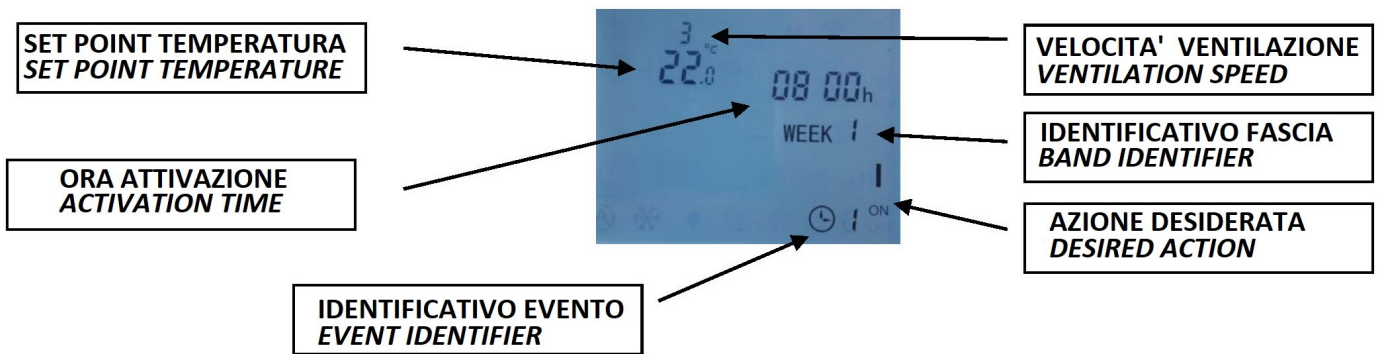
Fig. 12: Azioni selezionabili del display / Selectable display actions.
