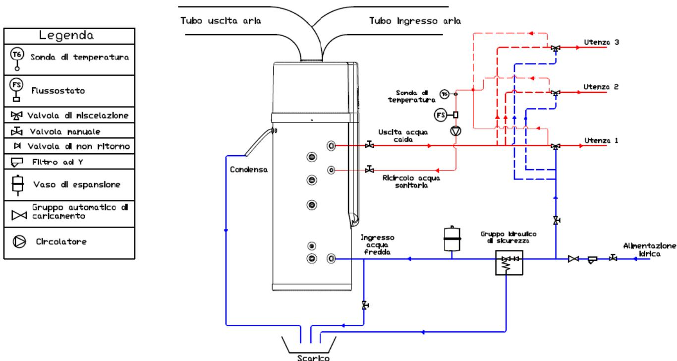
Schema di installazione in caso di ricircolo di acqua calda sanitaria
