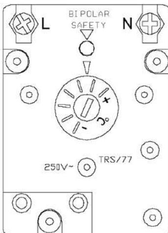
La resistenza elettrica di integrazione è equipaggiata con un termostato di regolazione; l'accesso a questo componente avviene rimuovendo la copertura frontale in plastica. Tale controllo permette una variazione di temperatura compresa fra 15 e 75 °C; ogni tacca di regolazione corrisponde ad un salto termico di 10°C.
