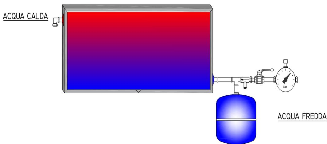
1. Collegare la valvola di sicurezza e non ritorno all'ingresso dell'acqua fredda a monte del vaso di espansione. Installare un vaso di espansione per ACS idoneamente dimensionato (almeno 10% del volume dell'accumulo)
