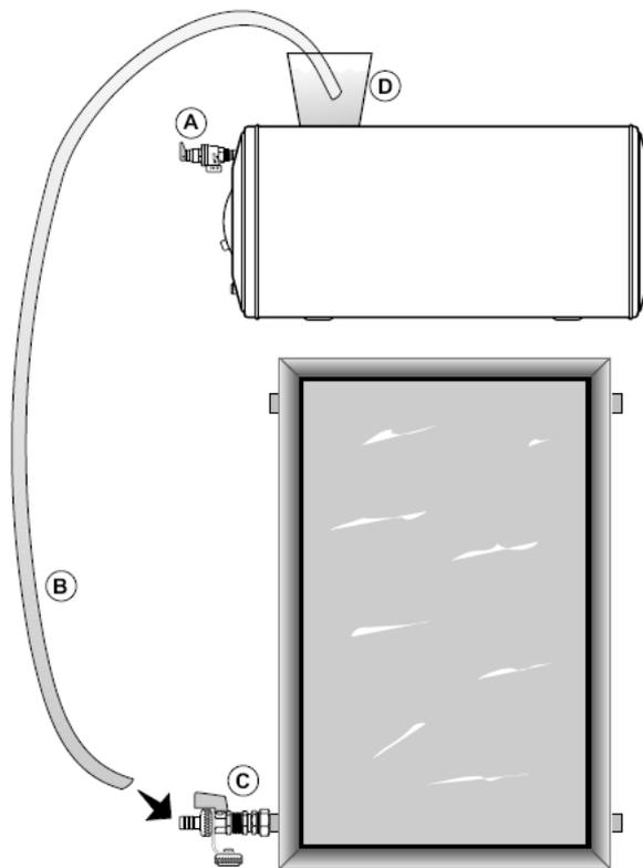
**Riempire assolutamente prima di tutto il circuito sanitario del bollitore per evitare implosioni al bollitore.**
